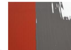
待第1层涂层达到触干后, 按500微米湿膜厚度涂覆第2层涂层。
